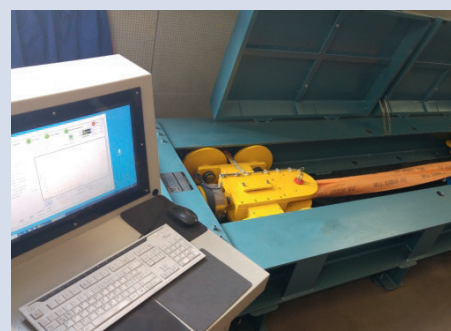
Mit der Investition in eine neue Maschine für Zerreiß- und Belastungsprüfungen bis 50 Tonnen haben die Verantwortlichen ein regionales Alleinstellungsmerkmal für ihr Unternehmen geschaffen. Foto: Daniel Puderbach
